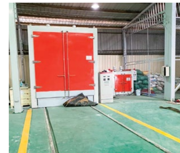
2. Hệ thống lò sấy chân không / Vacuum impregnated, baking oven system
