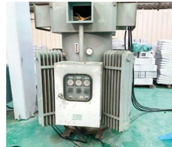
1. Máy biến áp xoay 450kVA 0-700V / 450kVA 0-700V/ Induction voltage regulator 450kVA 0-700V
